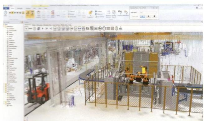
» Ena izmed možnih vizualizacij proizvodnje v programske opremi Tecnomatix Plant Simulation vključno s Point-Cloud okoljem (3D-skenirana proizvodnja)
